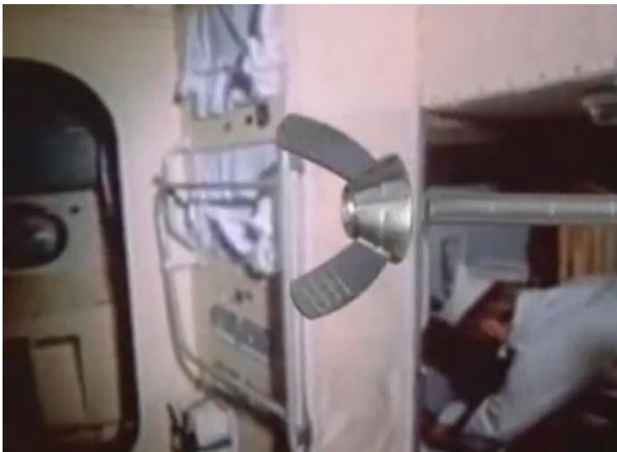
Рис. 40. Вращающаяся гайка с «ушками» слетает с резьбового крепления
