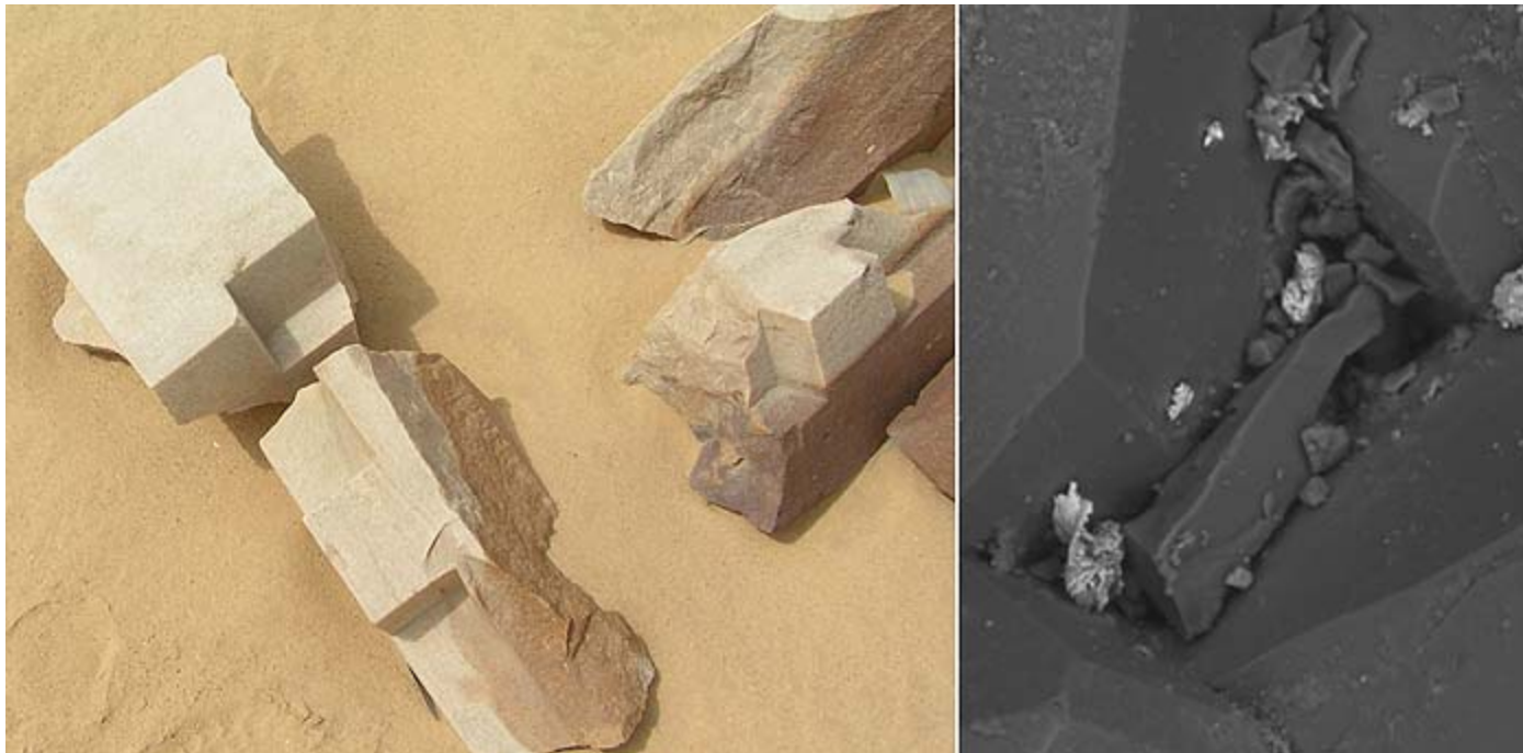
Рис. 16. Обломки кварцитового саркофага и микрочастицы инструмента на его поверхности
