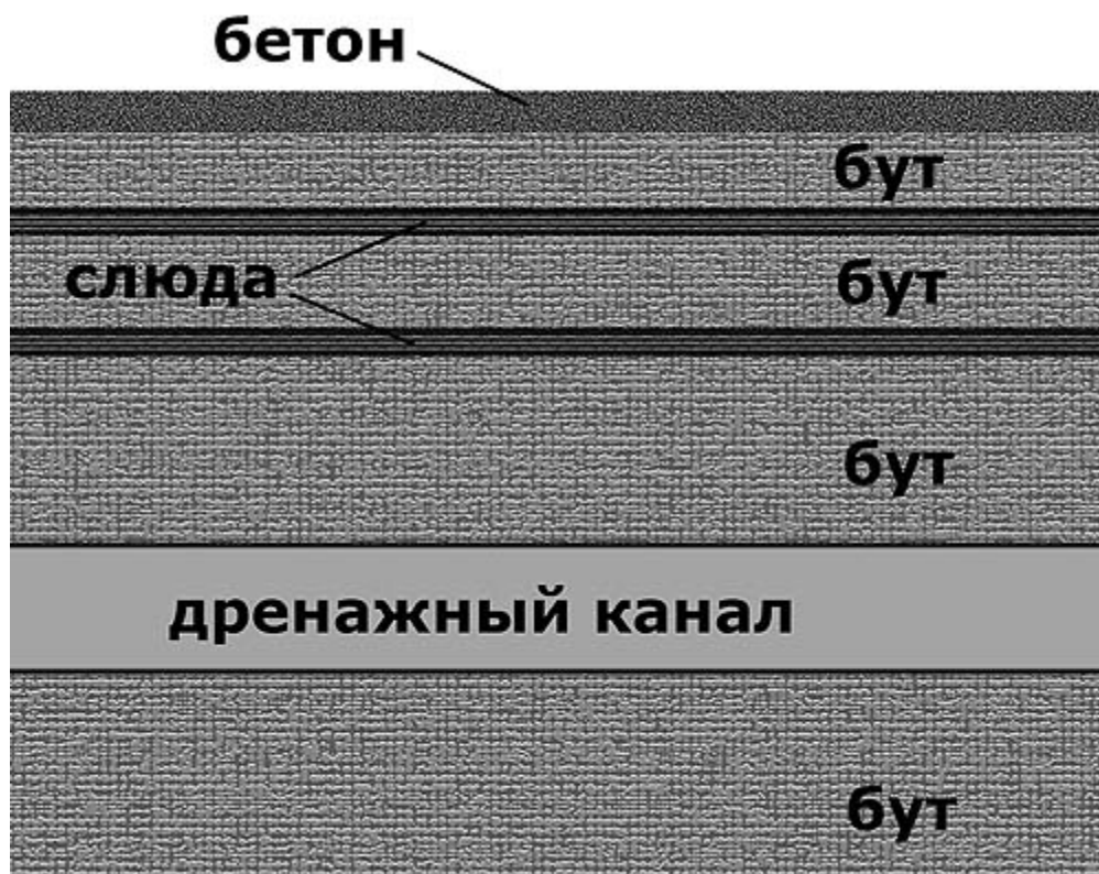
Рис. 76. Схема расположения слоев слюды в Слюдяном храме
