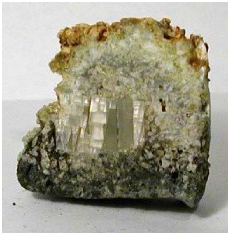
Рис.43. Оксид магния MgO, спеченный из гранул при температуре 1150 °С. В центре кубический кристалл периклаза в натуральную величину.
