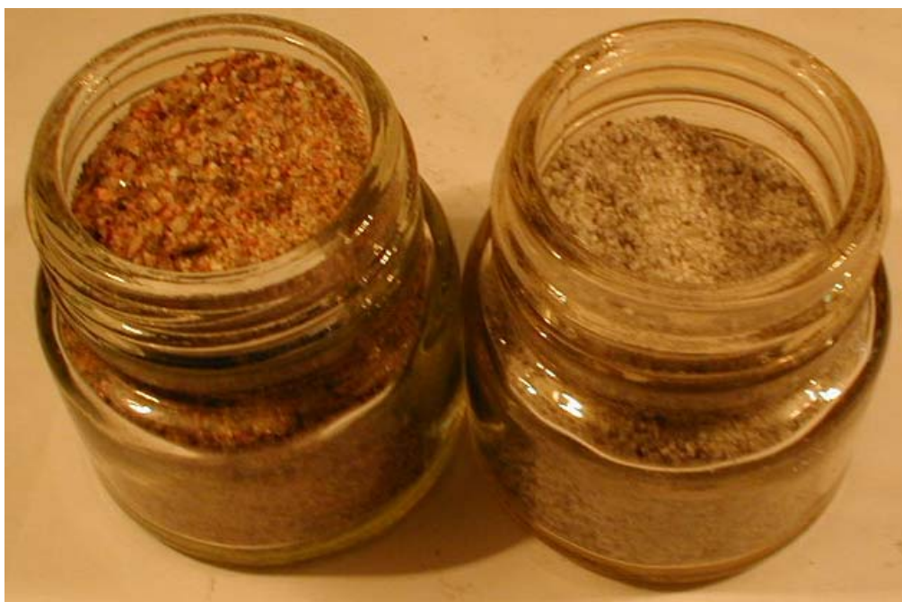
Рис. 26 Образцы речного кварцевого песка. Слева - загрязненный оксидами железа, справа - очищенный от оксидов железа.
