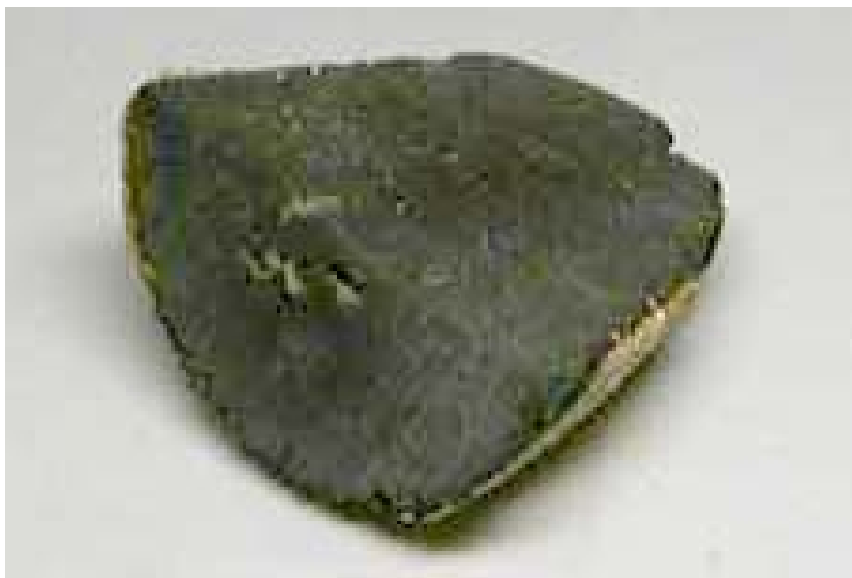
Рис. 40 Зола ТЭЦ, спеченная в каолиновом тигле при температуре 950 °С.
