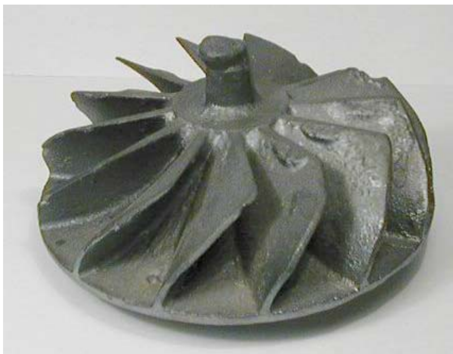
Рис. 37 Изделие сложной конфигурации из композиционного материала на основе карбида кремния и кремния.
