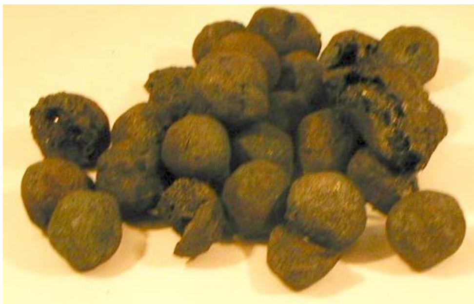
Рис. 21 Железорудные окатыши, металлизированные с использованием твердого углеродистого восстановителя в куполообразном нагревательном устройстве.
