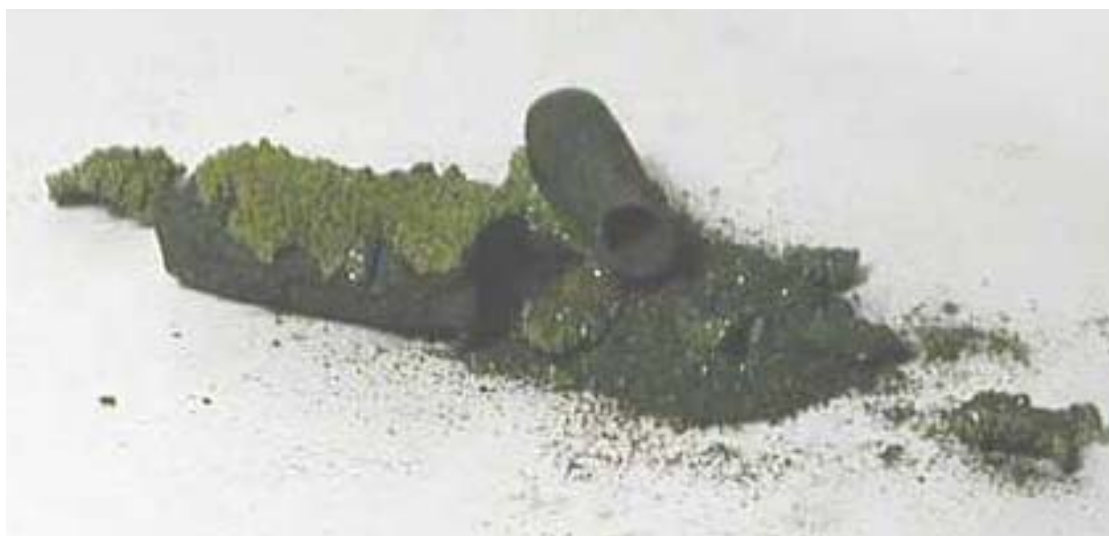
Рис. 16 Кубический карбид кремния (зеленый), полученный путем газофазного осаждения на графитовом нагревателе.
