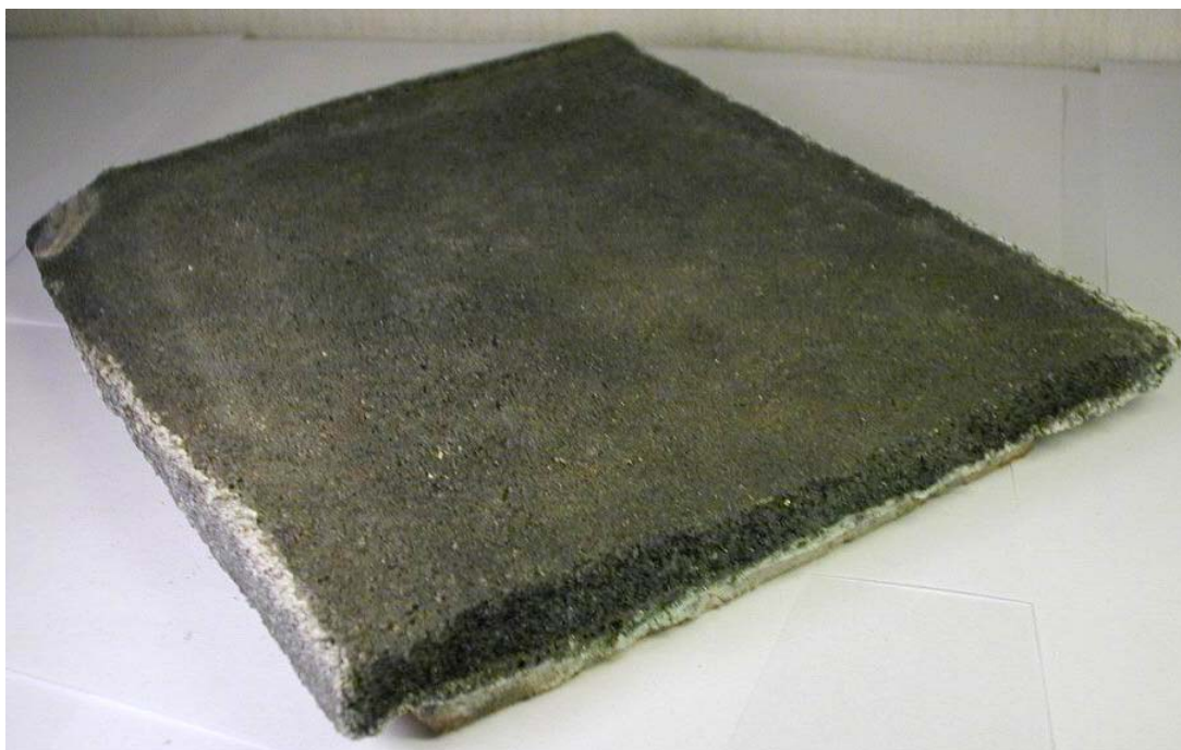
Рис. 38 Подина для обжига фарфоровых изделий, спеченная из порошкообразного карбида кремния на связке из жидкого стекла.
