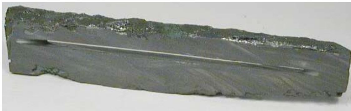
Рис. 36 Огнеупорное изделие из композиционного материала на основе карбида кремния и кремния.
