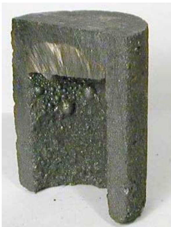
Рис.18 Компакт-слиток и корольки железа на внутренней поверхности графитового тигля.
