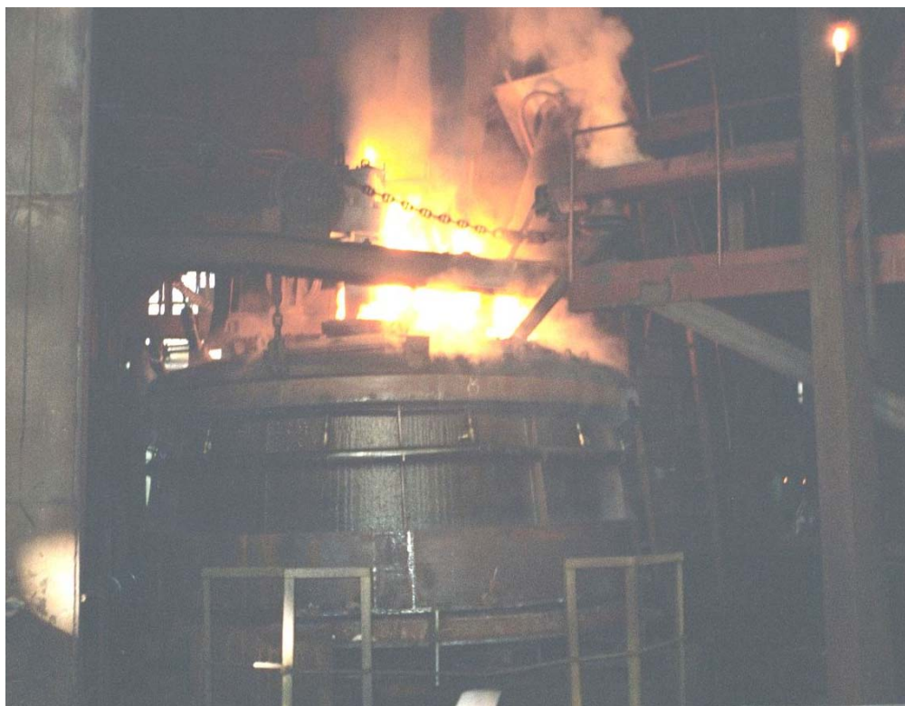
Рис. 66. Горение над водоохлаждаемым кожухом руднотермической печи оксида углерода, образующегося в процессе восстановления хромовой руды графитом.
