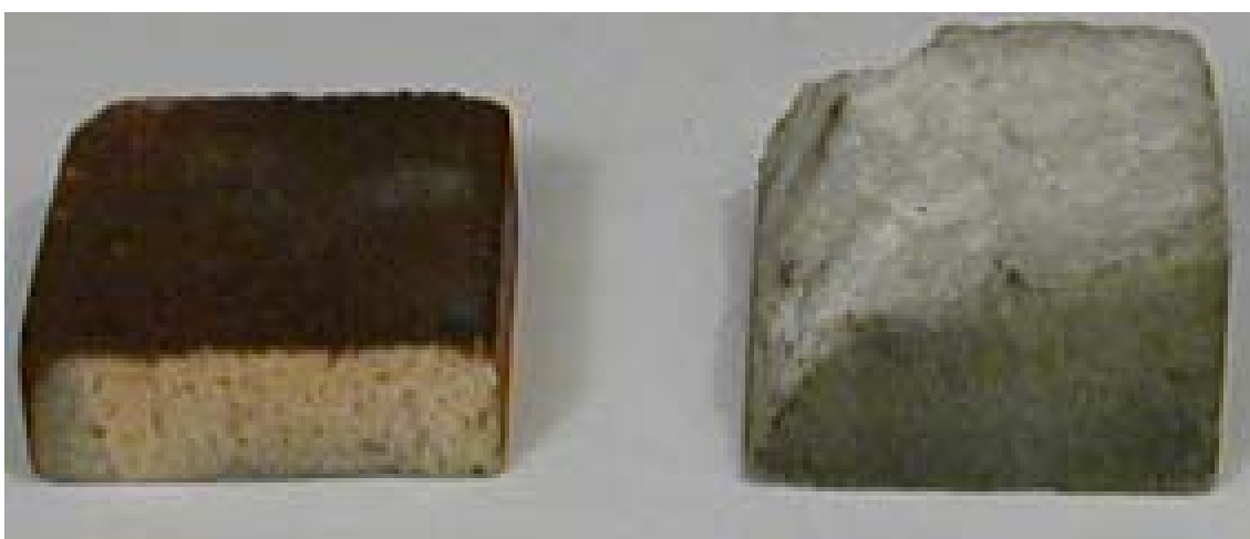
Рис. 24 Образцы плавленного оксида магния (периклаза). Слева - загрязненный оксидами железа, справа - очищенный от оксидов железа.
