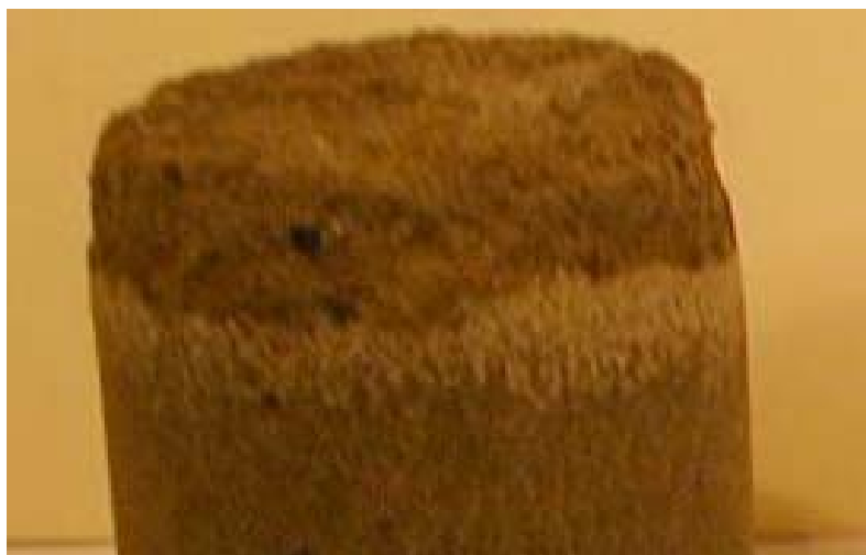
Рис. 19 Сегрегация диоксида вольфрама от нерудной фазы при восстановлении шеелитового концентрата.
