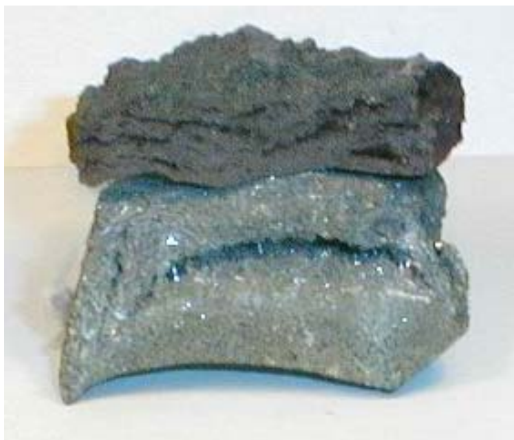
Рис.20 Сегрегация диоксида молибдена от нерудной фазы при восстановлении молибденового огарка.
