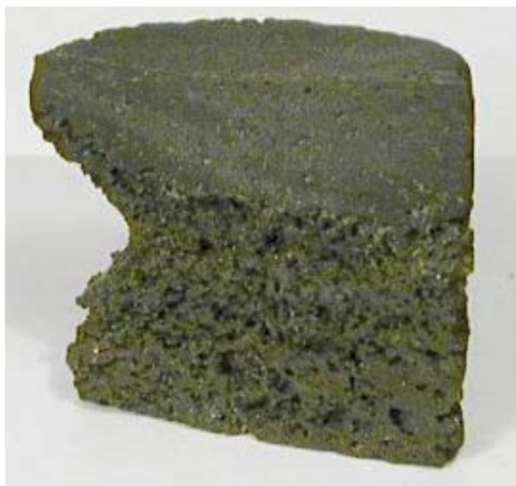
Рис.22 Сегрегация металлизированной фазы от кремнезема при восстановлении железистых кварцитов КМА.
