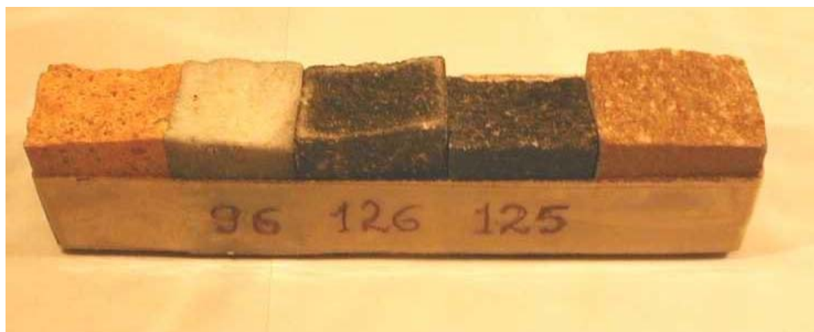
Рис. 25 Образцы плавленного оксида магния (периклаза) после прямого восстановления при различных температурах.
