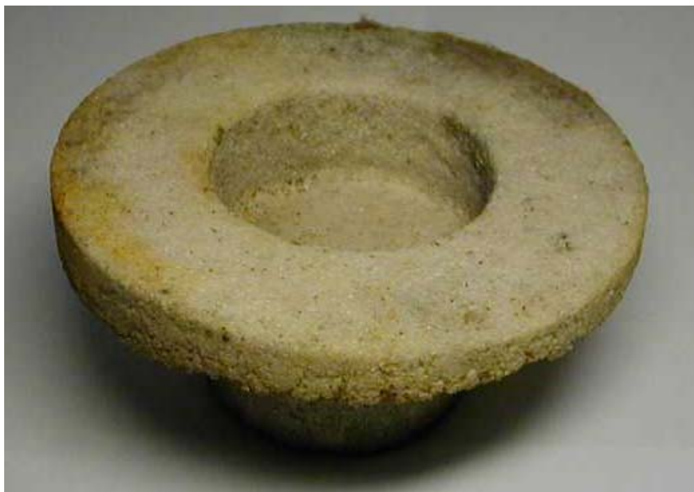
Рис. 42 Изделие сложной конфигурации, спеченное из оксида циркония.
