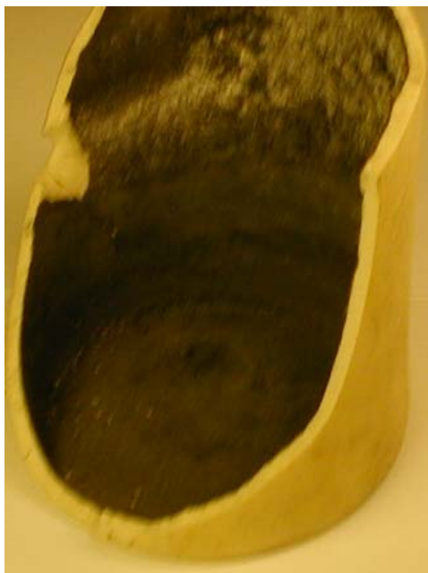
Рис.17 Внутренняя поверхность фарфорового стакана, почерневшая от контакта с водородом.
