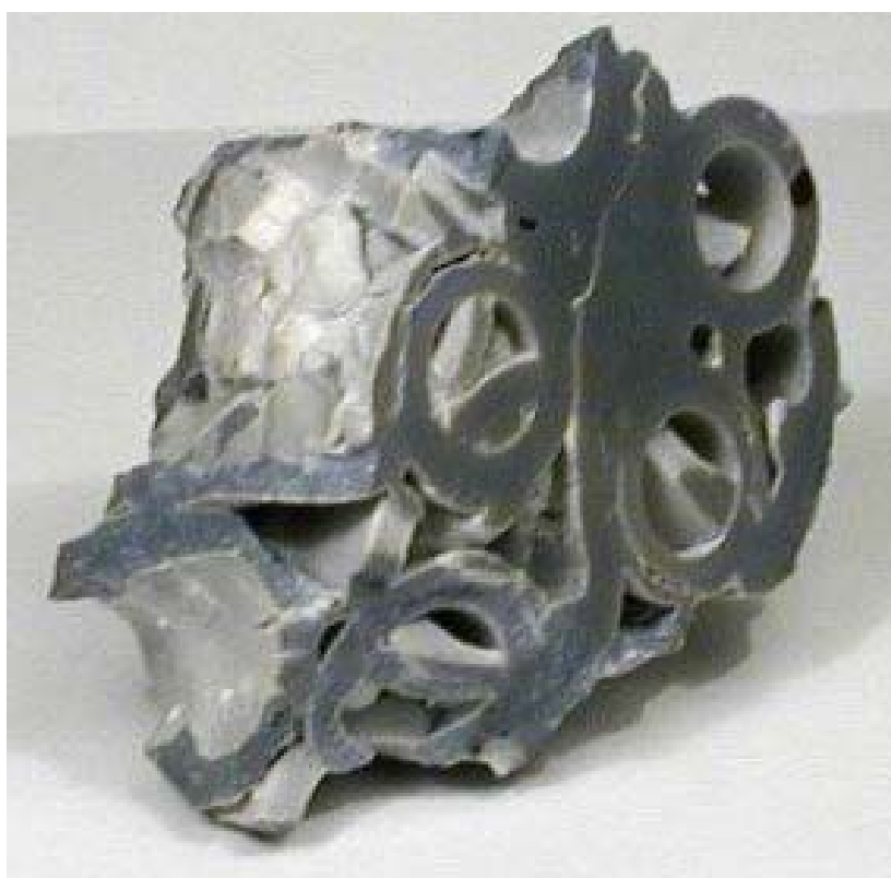
Рис.44. Трубки из оксида алюминия, спеченные во влажной среде при температуре 1150 °С.
