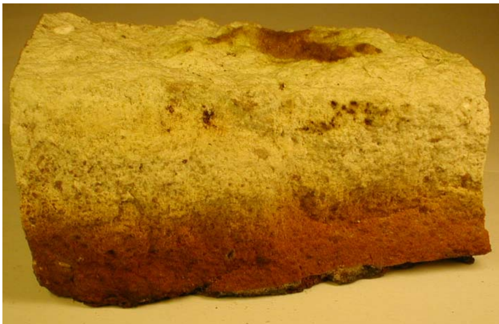
Рис. 23. Образец магнезиального огнеупорного кирпича, частично очищенный от оксидов железа (белый цвет).
