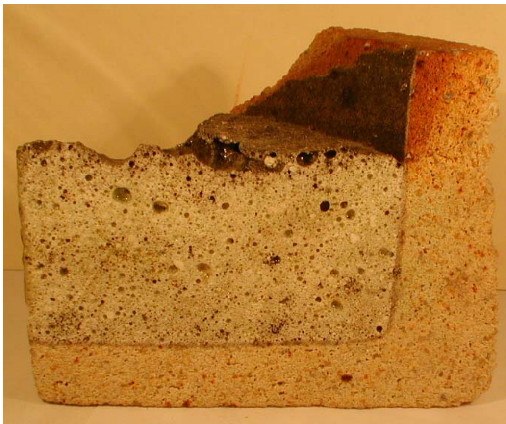
Рис. 39 Кварцевый песок, спеченный в каолиновом тигле при температуре 950 °С.
