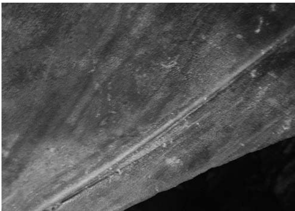
Рис. 57. Следы инструмента на «саркофаге» в пирамиде Тети
