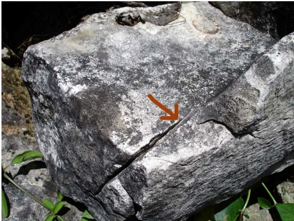
Рис. 143. След круглой фрезы
