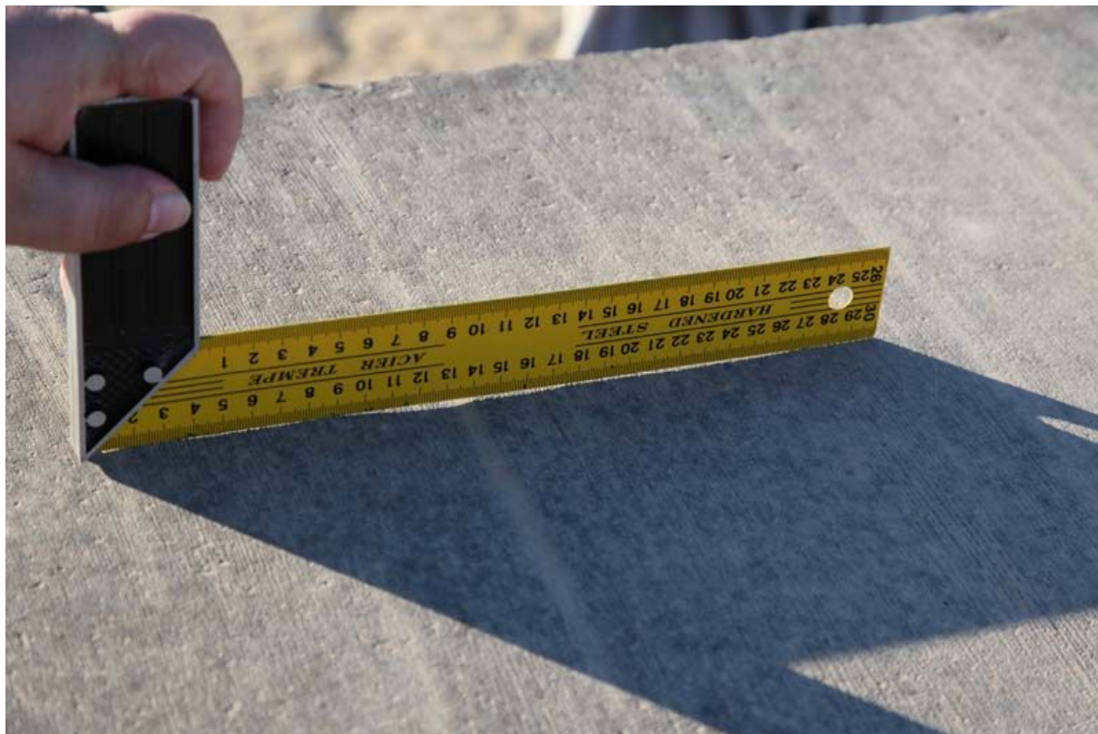
Рис. 84. Неровность распиленной поверхности
