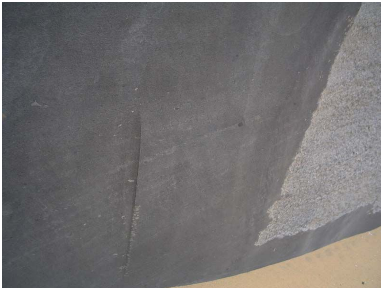
Рис. 54. След от дисковой пилы на блоке черного базальта
