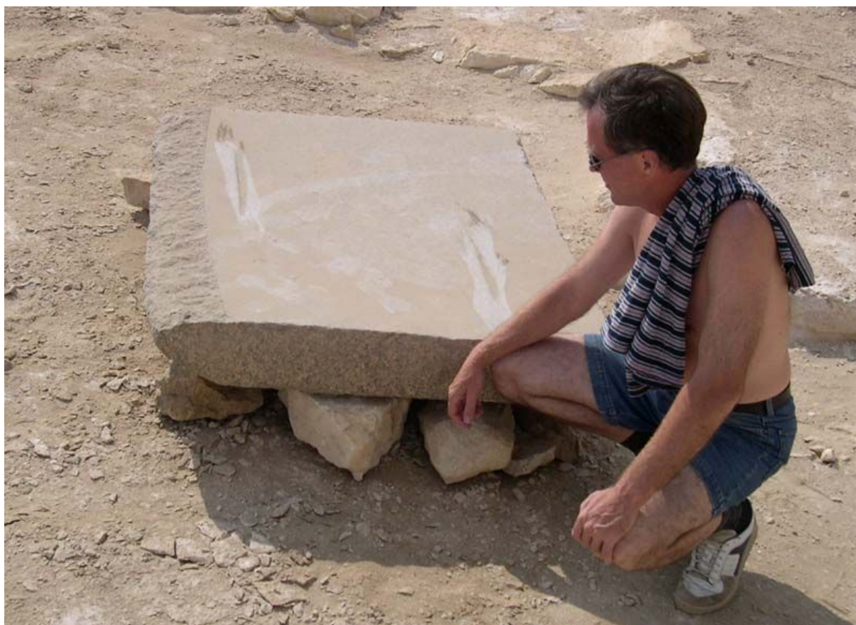
Рис. 81. Гранитный блок со следами дисковой пилы в Абу-Роаше
